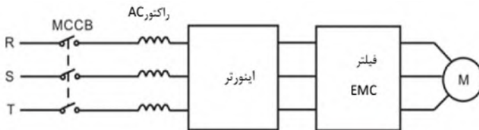
نصب فیلتر EMC در خروجی درایو
